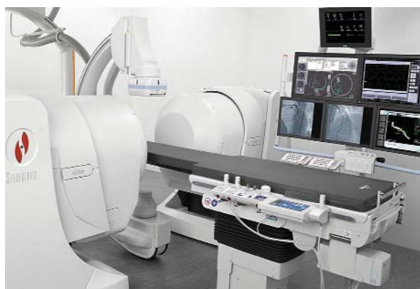
Ryc. 1A. System przygotowany do wykonywania interwencji z nawigacją magnetyczną. Widoczne dwa magnesy umieszczone po obu stronach stołu zabiegowego Fig. 1A. Magnets in Navigate Position – for Magnetic Assisted Interventions
