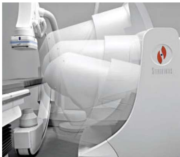
Ryc. 2. Komputery sterujące systemem mogą zmieniać położenie magnesów, co ułatwia skomplikowane zabiegi
