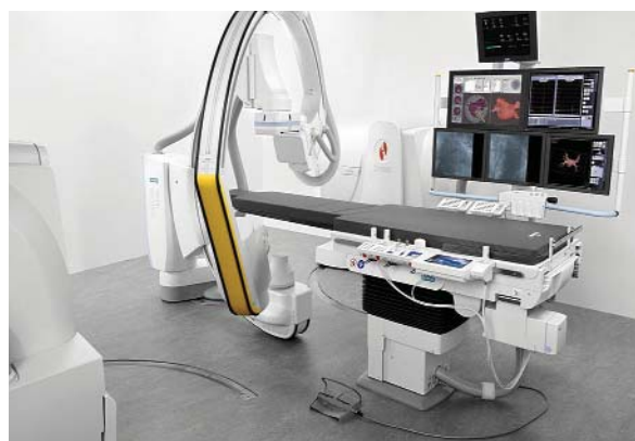
Ryc. 1B. System z magnesami w pozycji „zaparkowanej”, gotowy do wykonywania rutynowych interwencji. Magnesy nie ograniczają ruchomości lampy Fig. 1B. Magnets in Stowed Position – Standard CathLab Application
