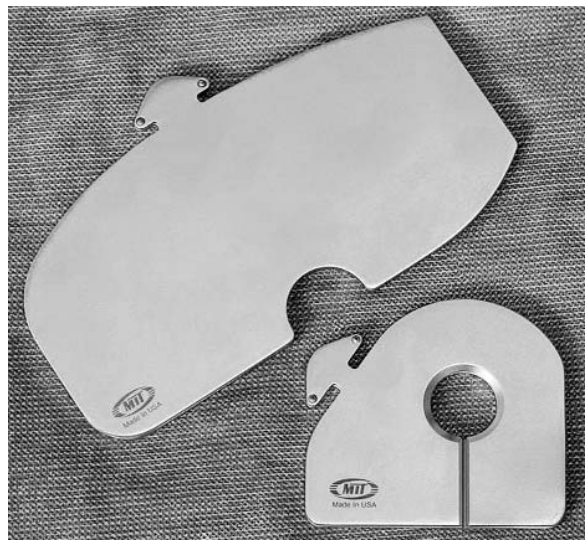
Ryc. 1. Matryce o ściśle określonym kształcie i rozmiarze wykorzystywane do nadania elementom siatki odpowiednich parametrów
