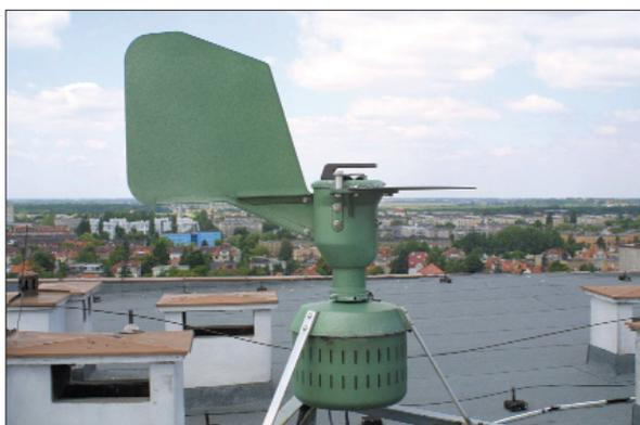
Fig. 1. Burkard volumetric trap
